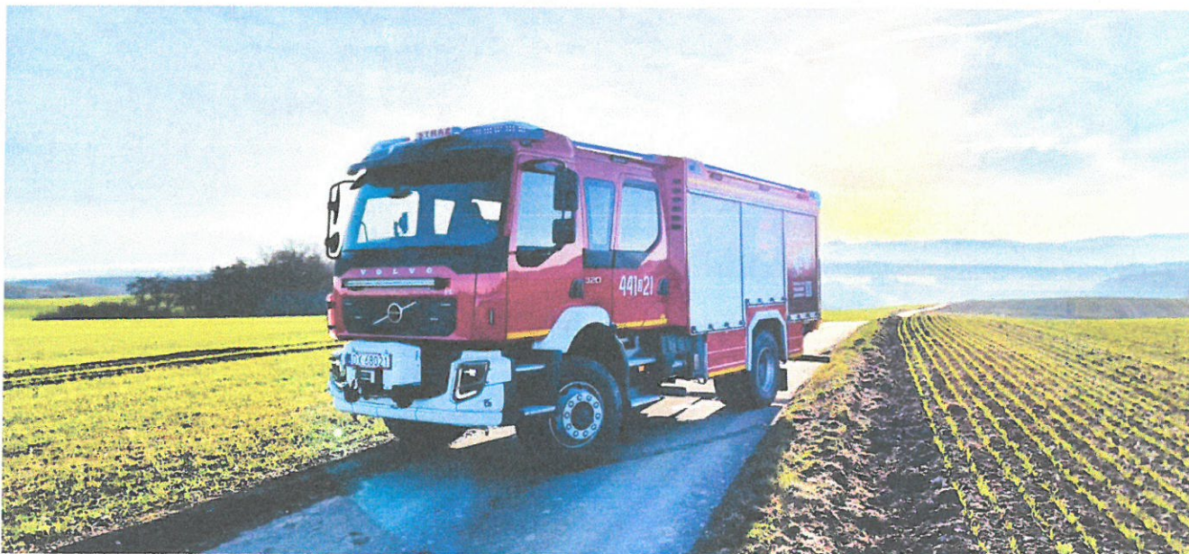
Rysunek 14 Nowy pojazd GBA 3/27 na podwoziu Volvo
